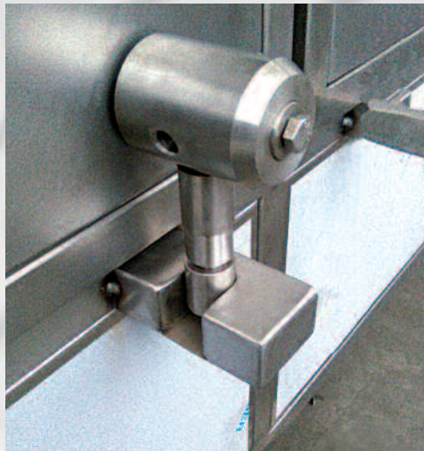
Particolare della chiusura delle porte ad alta resistenza.
