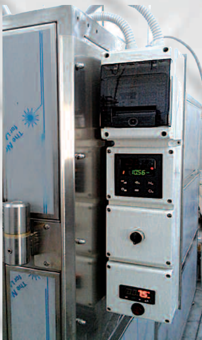
Particolare del quadro elettrico stagno con termoregolatore, accensione temporizzata, svariati programmi di cottura personalizzabili e sonda al cuore.
