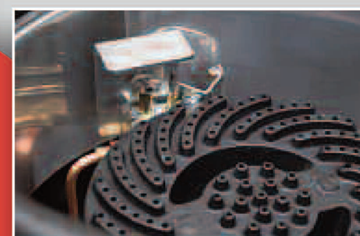
bruciatore in ghisa sferoidale con potenza da 7,5 a 16,5 Kw, con gruppo fiamma pilota e protezione inox
