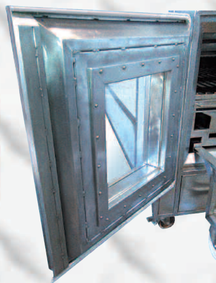
Particolare della porta di chiusura con cm. 10 di isolamento e guarnizioni per alte temperature: peso porta kg. 50.
