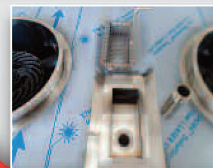
Cesto inox per raccolta rifiuti con foro per "Troppo pieno" e relativa vaschetta ricavata dal piano
