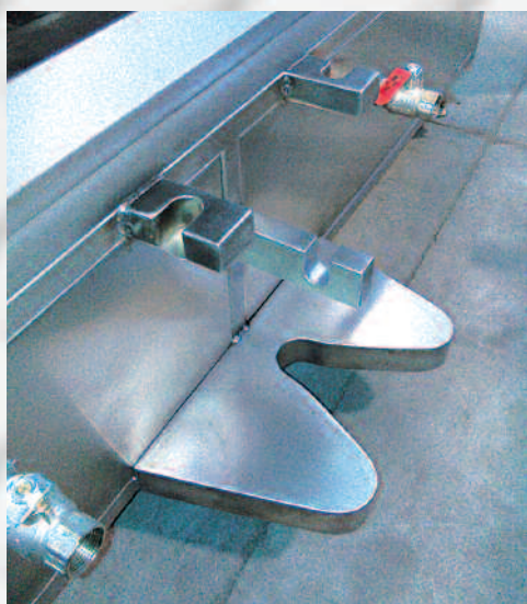
Particolare dell'aggancio dei carrelli al forno. In evidenza saracinesca da 1" per scarico acque di lavaggio.
