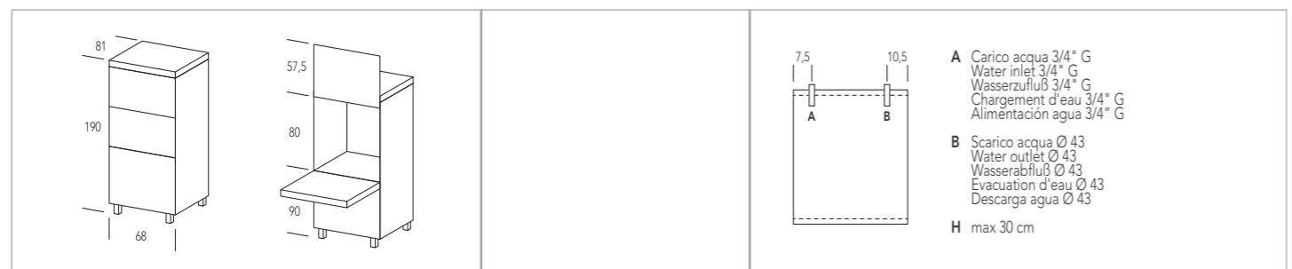
**MLP60E** - Macchine ad alte prestazioni perché costruite con caratteristiche di affidabilità e robustezza: bracci di lavaggio e risciacquo, tubazioni, boiler, filtri, tutto in acciaio inox AISI 304. Finitura esterna SCOTCH-BRITE. Cesto quadro 55 x 69. Macchine lavaoggetti, ideali per l'utenza che desidera sfruttare al massimo la capacità di lavaggio delle macchine; consigliate per il lavaggio di utensili per pasticceria, gelateria e gastronomia.
