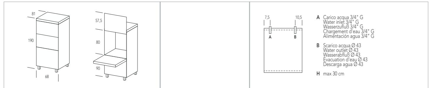
**MLP60E** - Macchine ad alte prestazioni perché costruite con caratteristiche di affidabilità e robustezza: bracci di lavaggio e risciacquo, tubazioni, boiler, filtri, tutto in acciaio inox AISI 304. Finitura esterna SCOTCH-BRITE. Cesto quadro 55 x 69. Macchine lavaoggetti, ideali per l'utenza che desidera sfruttare al massimo la capacità di lavaggio delle macchine; consigliate per il lavaggio di utensili per pasticceria, gelateria e gastronomia.
